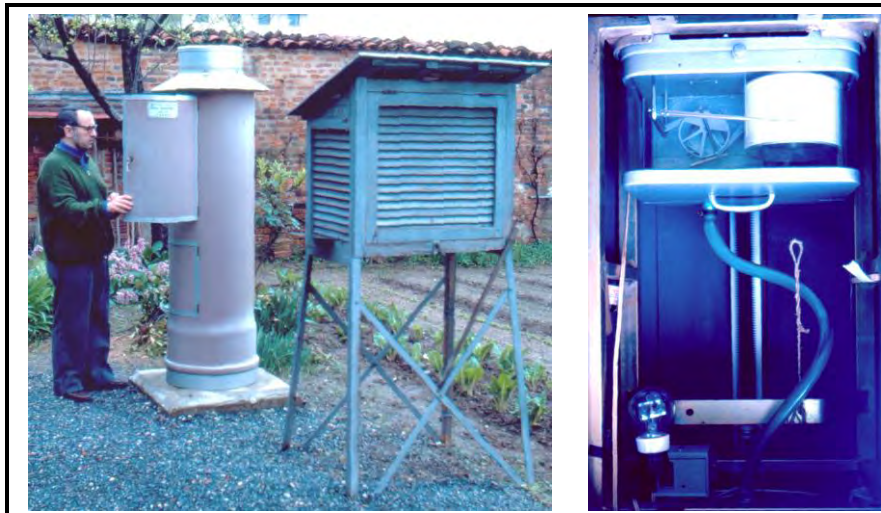
Fig. 1.39 - A sinistra una capannina meteorologica con strumenti per la misura dei parametri atmosferici ad altezza d'uomo ed un pluviometro a forma di cilindro sormontato dall'imbuto che raccoglie l'acqua delle piogge (vedi anche fig. 1.11 ). A destra si osservano i meccanismi interni del pluviometro, che consentono la rilevazione continua della quantità di precipitazione.
