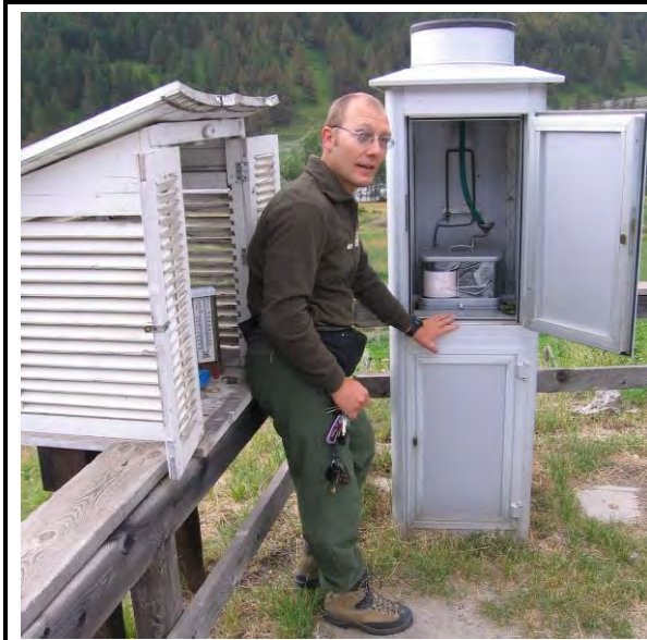
Fig. 1.11 - A sinistra una “vecchia” capannina meteorologica con strumenti per la misura dei parametri atmosferici ad altezza d’uomo; le persiane consentono la libera circolazione dell’aria nell’interno riparato dalla radiazione solare diretta. A destra si osserva una struttura più “moderna”, sovrastata da una apertura che consente all’acqua delle precipitazioni di raccogliersi all’interno per la misura delle quantità; sono visibili gli strumenti in grado di misurare “in continuo” i parametri atmosferici (essenzialmente termografi e pluviografi). Soprattutto merita osservare, nella capannina di sinistra, la presenza di un semplice termometro “manuale” a massima ed a minima, utile nel caso in cui gli strumenti più “sostanziosi” dovessero guastarsi.
