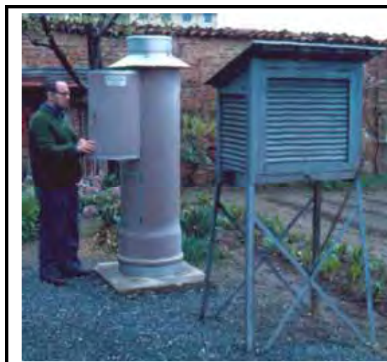
Fig. 1.36 - Il pluviometro più semplice è formato da un imbuto che raccoglie le acque di precipitazione in un cilindro graduato.
