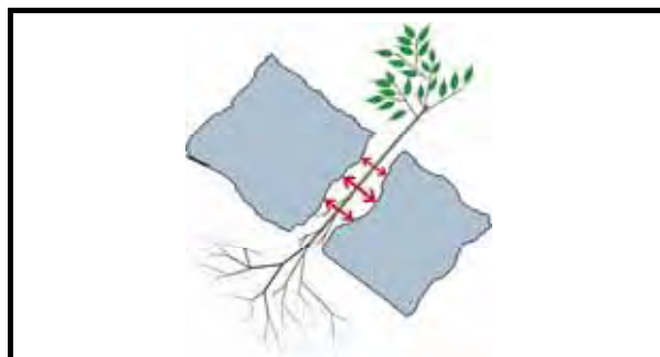
Fig. 1.61 - Esempio di intervento di difesa spondale con le tecniche dell'ingegneria naturalistica.
