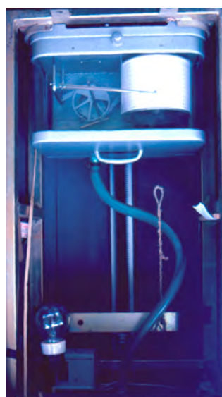
Fig. 6 - A sinistra una capannina meteorologica con strumenti per la misura dei parametri atmosferici ad altezza d'uomo ed un pluviometro a forma di cilindro sormontato dall'imbuto che raccoglie l'acqua delle piogge (vedi anche fig. 2 ). A destra si osservano i meccanismi interni del pluviometro, che consentono la rilevazione continua della misura della pioggia.
