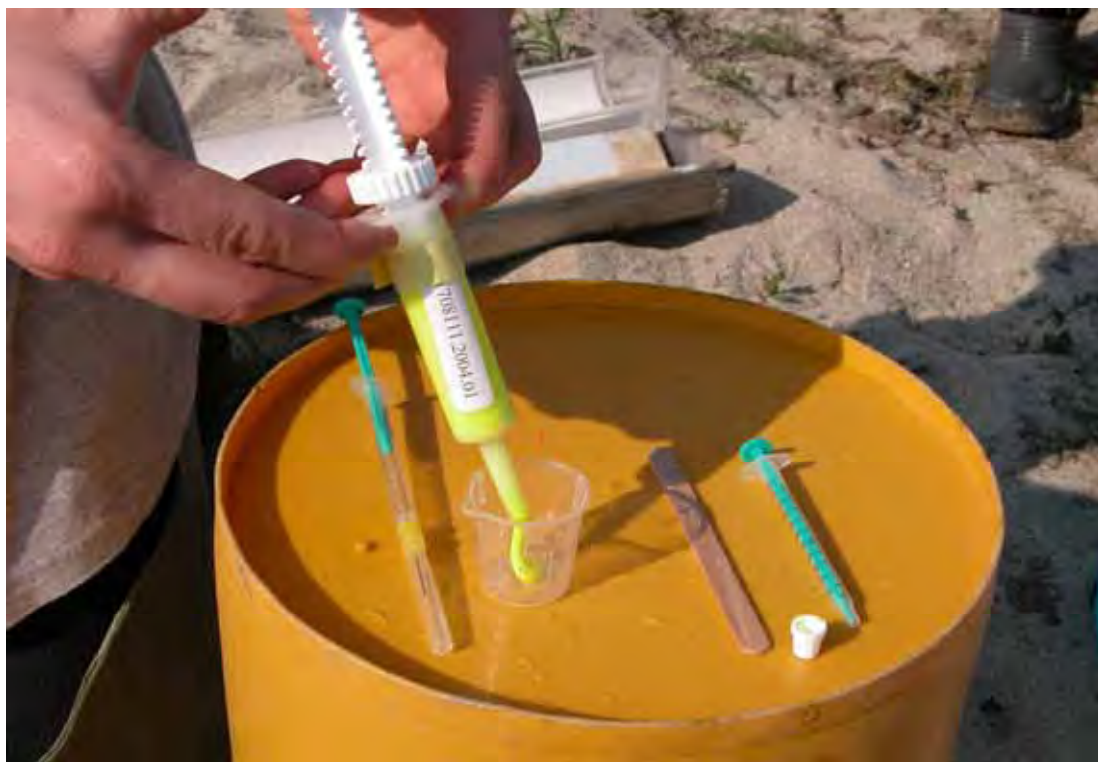
Fig. 7.10 - Preparazione di un elastomero giallo. Esso si ottiene mescolando una dose di solvente (0,1 ml) con il colorante (1 ml) in rapporto 1:10.
