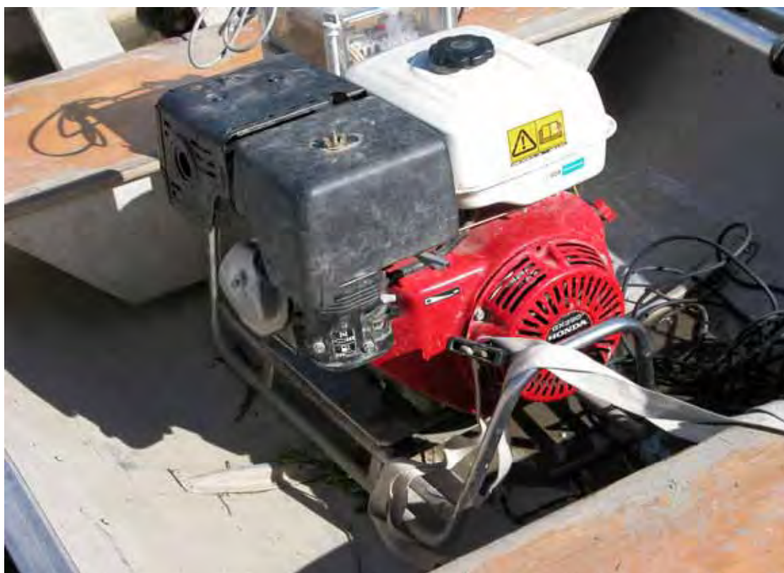
Fig. 3.1 - Campionamento relativo all'ittiofauna mediante elettroscorditore spalleggiabile a batteria A.G.K. IG 200/2 (sopra). Per gli ambienti di ampie dimensioni (soprattutto per profondità superiori a 1,5 - 2 m) è stata utilizzata un'apparecchiatura con motore a scoppio da 8 kW (sotto; modello EFKO FEG. 8.000 c/c 8 kW).
