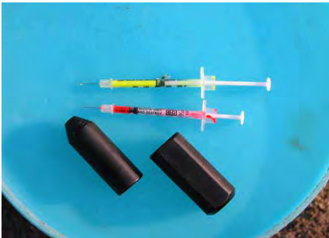
Fig. 7.11 - Una volta ottenuta la miscela (elastomero), questa viene introdotta in apposite siringhe (nell'immagine ne appaiono due con i colori giallo e rosso) a loro volta introdotte in contenitori a pressione che consentono l'iniezione di una dose per la marcatura di un individuo.
